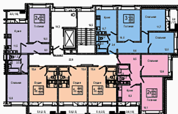
Жилой дом №2. Секция № 1. План типового этажа.
